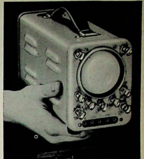
Bild 14. Ein sehr kleiner Service-Oszillograf für den Fernseh-Reparaturfachmann. Gewicht: 4,5 kg, eingebauter einstufiger, umschaltbarer Verstärker, entweder max. Bandbreite 1,5 MHz (g = 20) oder 120 kHz (g = 75), Oszillator-Röhre 7 cm Ø, Gehäuseabmessungen: 30 x 11,5 x 14,5 cm (Cossor Modell 1039 M)
