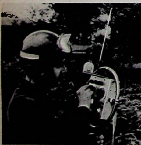
Ein besonders raumsparendes Peilgerät für Kraftfahrer; der Empfänger ist innerhalb des Peilrahmens angeordnet
