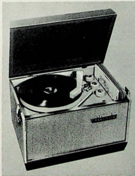
Bild 6. Plattenspieler mit batteriegespeistem Motor für Kleinplatten mit 45 U/min, Verstärker mit vier Transistoren. Ein Batteriesatz reicht für 1500 Plattenseiten; Anschluß für Mikrofon (Philco)
